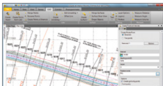
Cree puntos automáticamente con un desplazamiento horizontal y vertical respecto de un eje para fines de replanteo
